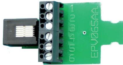
El cable de conexionado entre el adaptador de sondas RJ12 y la maleta SenNet Case, se habrá mediante un cable RJ12, macho en ambos extremos, pin a pin, según la siguiente ilustración:
