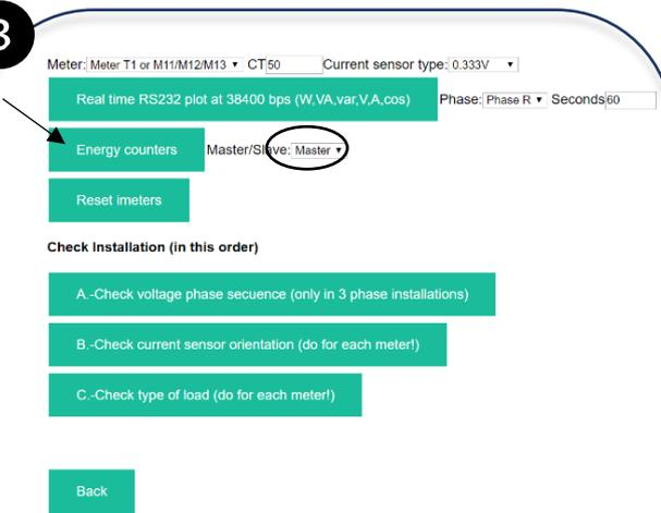
Escoja si desea modificar los contadores del propio DATALOGGER (Master) o de un Slave.
